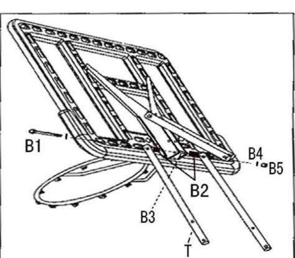
Затяните гайки до тех пор, пока они не окажутся заподлицо с болтом
