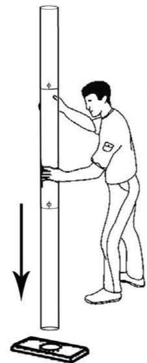
Соедините отверстие нижней части средней секции с отверстием верхней части нижней секции
