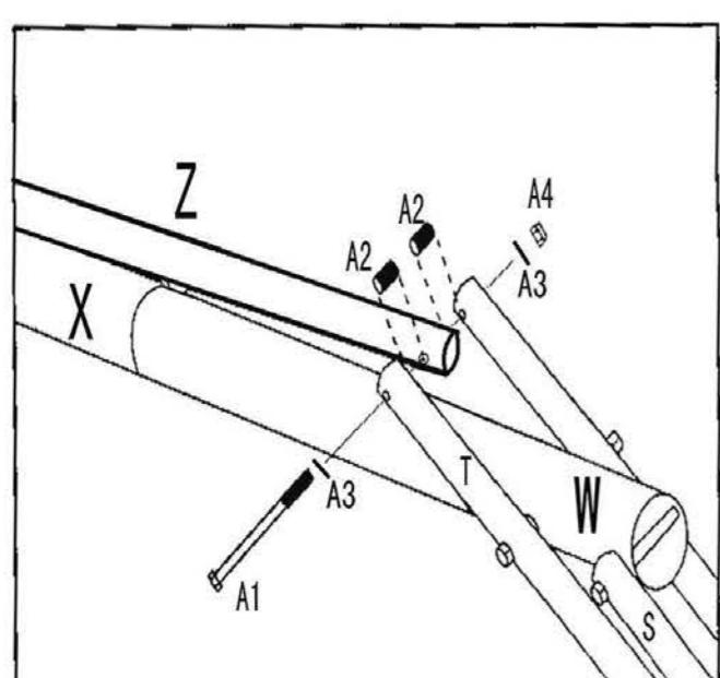
Надежно затяните гайки.
